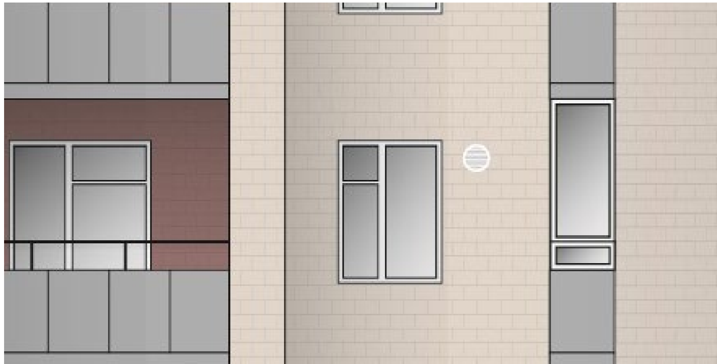
Скрытый кондиционер. Можно установить кондиционер внутри помещения (моноблок) и разместить вентиляционную решетку диаметром не более 20 сантиметров на лицевом фасаде.
