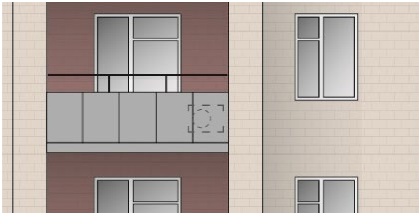
В нишах и лоджиях. Кондиционер можно разместить в нише или на лоджии лицевого или дворового фасада в незаметном с улицы месте.
